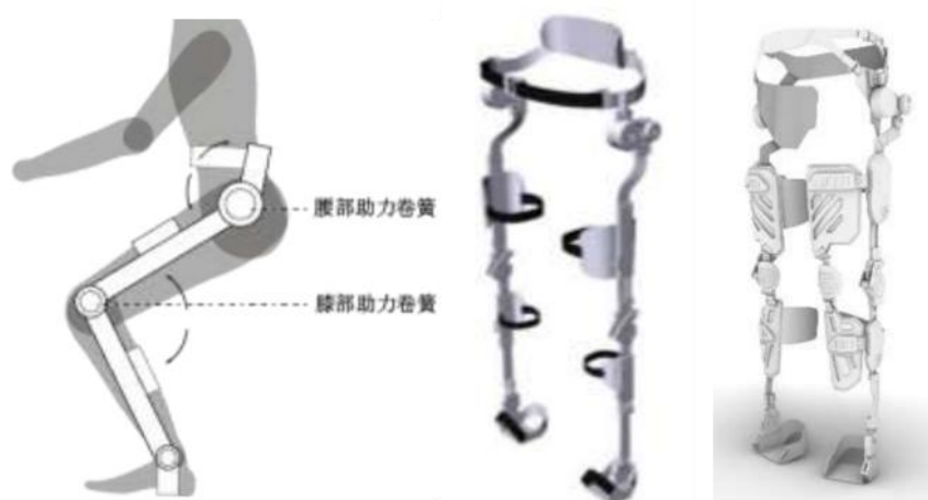
图3 消防下肢外骨骼助力方式、结构及其设计渲染图
